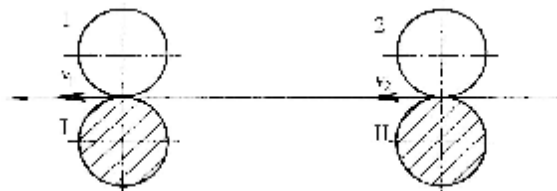
Obr. 1 Schéma základního průtahového ústrojí [1] (1 ... odváděcí válečky, 2 ... přiváděcí válečky)
