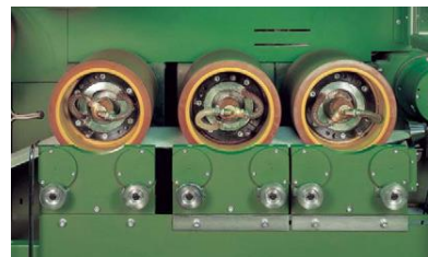
Trhací hlava trhacího konvertoru 873 Seydel
