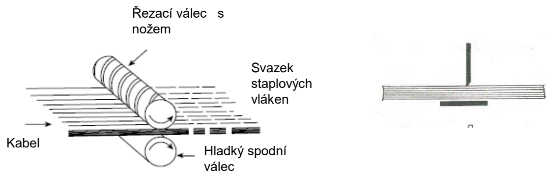
Princip řezání (drcení) vláken na konvertoru [1],[2]
