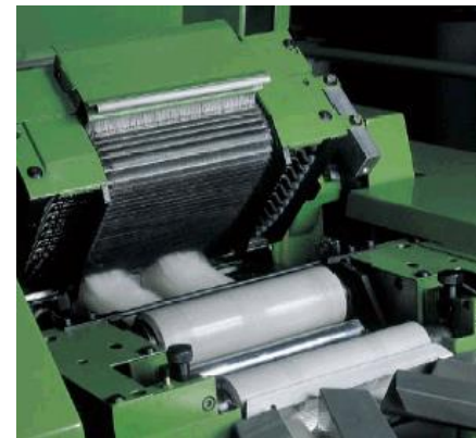
Hřebenové průtahové ústrojí konvertoru 911 Seydel [2]
