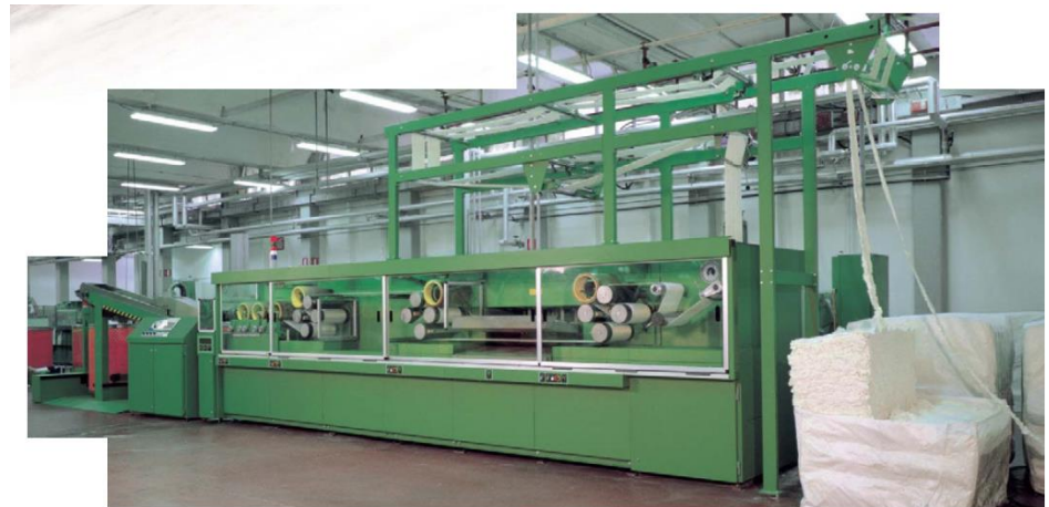
Trhací konvertor MSC8 – fa Cognetex [2]
