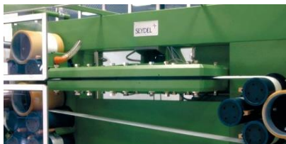
Dlouhící zóna trhacího konvertoru 873 Seydel
