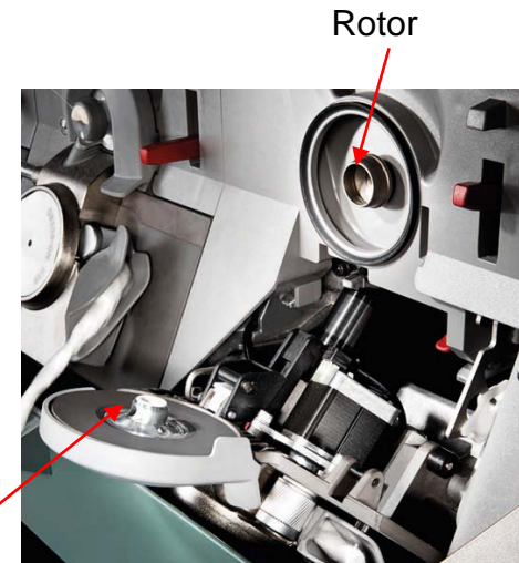
Otevřená spřádací jednotka stroje R66 - Rieter [3]
