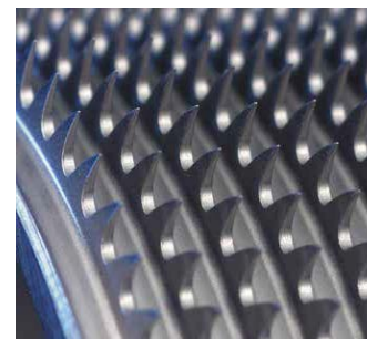
Detail povlaku vyčesávacího válečku
