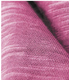
Pletenina z efektní příze z rotorového DS a ukázka efektů [2]
