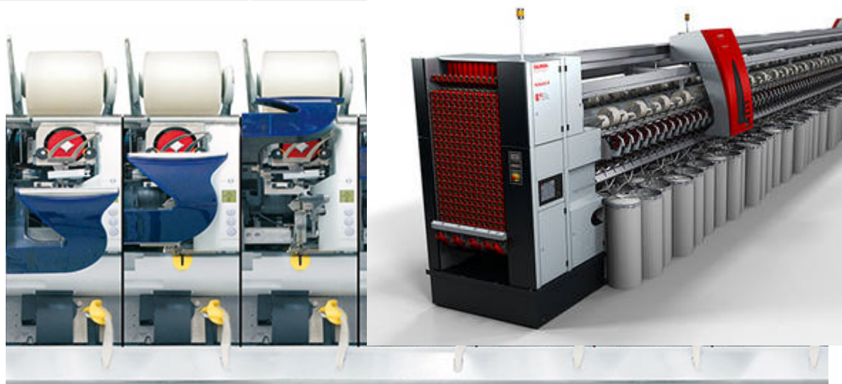
Rotorový dopřádací stroj Autocoro 8 - Schlafhorst [2] a Autocoro 9 – Saurer [3]
