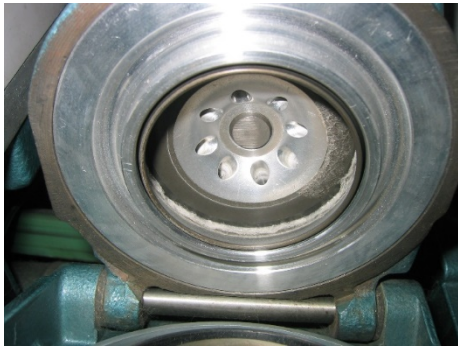
Vlákenná stužka v rotoru spřádací jednotky – rotorový dopřádací stroj BD 200 RN – foto KTT
