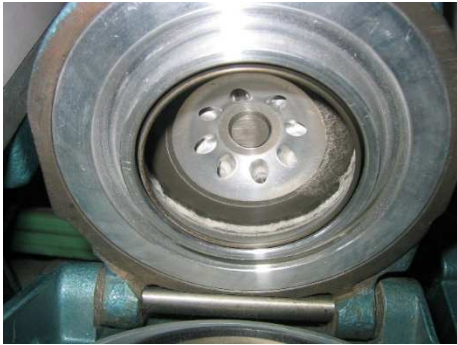
Vlákněná stužka v rotoru spřádací jednotky – rotorový dopřádací stroj BD 200 RN – foto KTT
