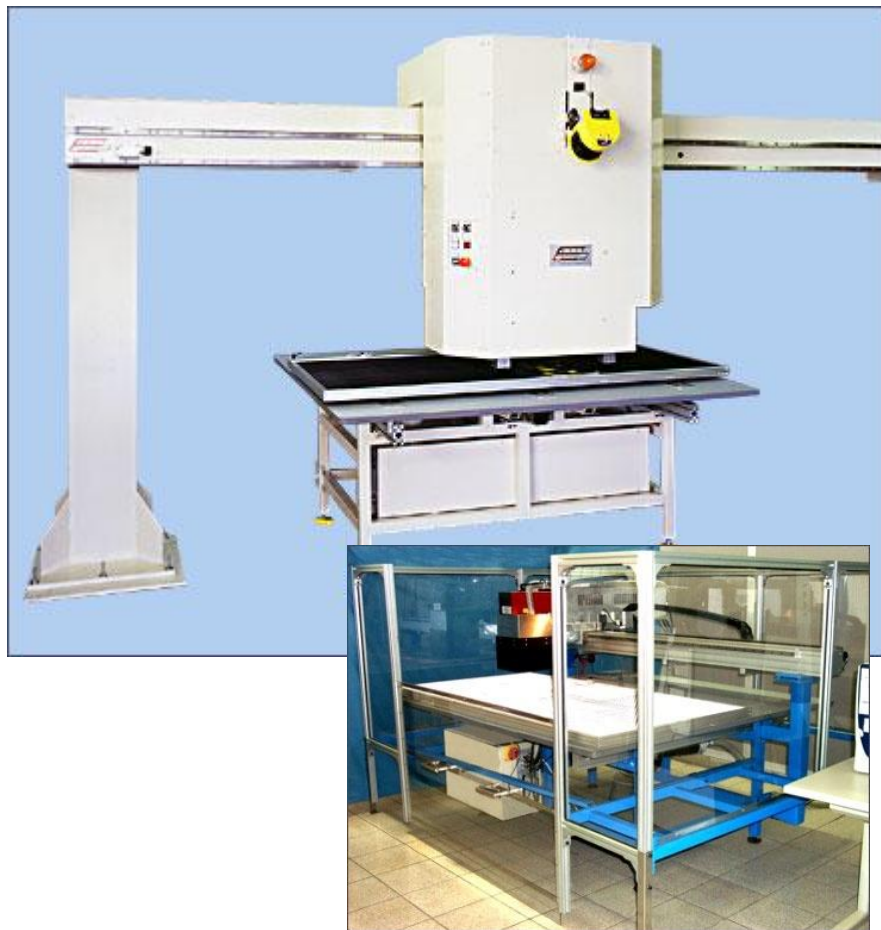
Řezání a gravírování materiálu na stole ploteru.
