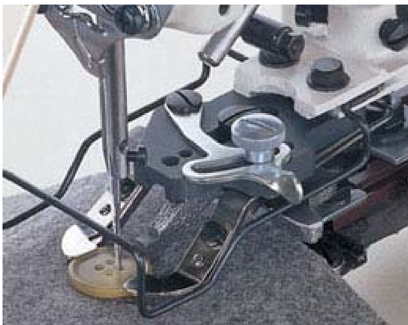
Obrázek 1: Přišití plochého knoflíku
