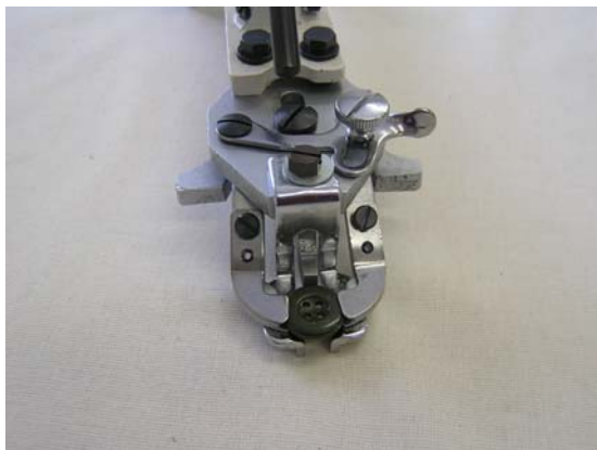
Obrázek 9: Přítlační držák knoflíku
