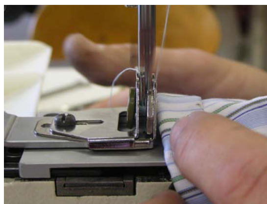
Obrázek 17: Vytvoření krčku knoflíku
