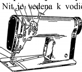
Obr. 12 Nit'ová páka na jehelní tyči ve spojení se stavitelnými vodiči
