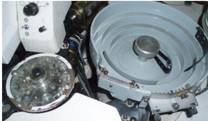
Obrázek 66: Miska na knoflíky automatického podávání knoflíku stroje Juki
