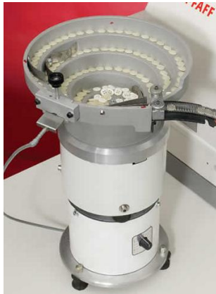
Obrázek 65: Miska na knoflíky automatického podávání knoflíku stroje Pfaff [25]
