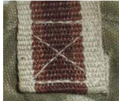
Obrázek 79: Popruh přišit na tvarovém stroji
