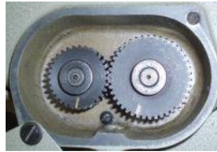
Obrázek 29: Výměna ozubených kol
