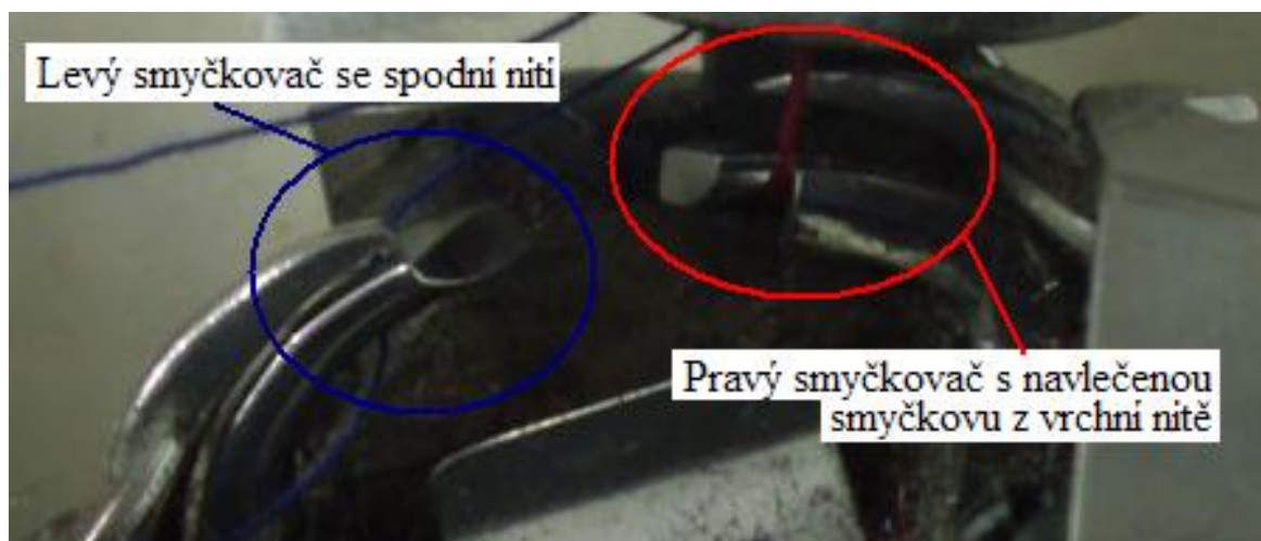
Obrázek 36: Levý a pravý smyčkovač konfekčního dírkovacího stroje
