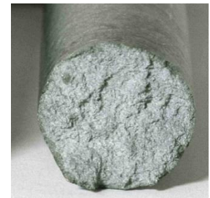
Modifikováno: Lom houževnatý s matným a jemným povrchem.
