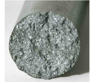
Nemodifikováno: Lom křehký s hrubými lesklými útvary na povrchu.
