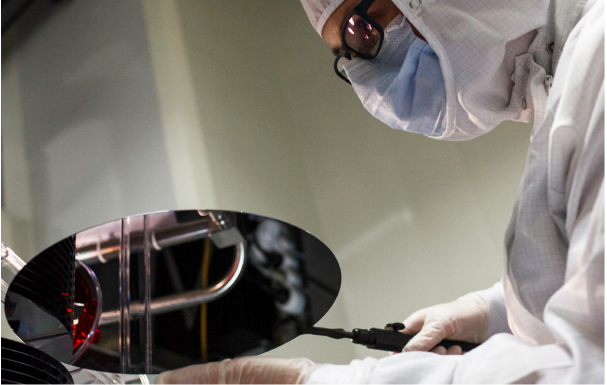
↑ Pracovník manipulující s 300mm křemíkovým waferem ve sterilní místnosti, Grenoble, Francie, 4. února 2022.
