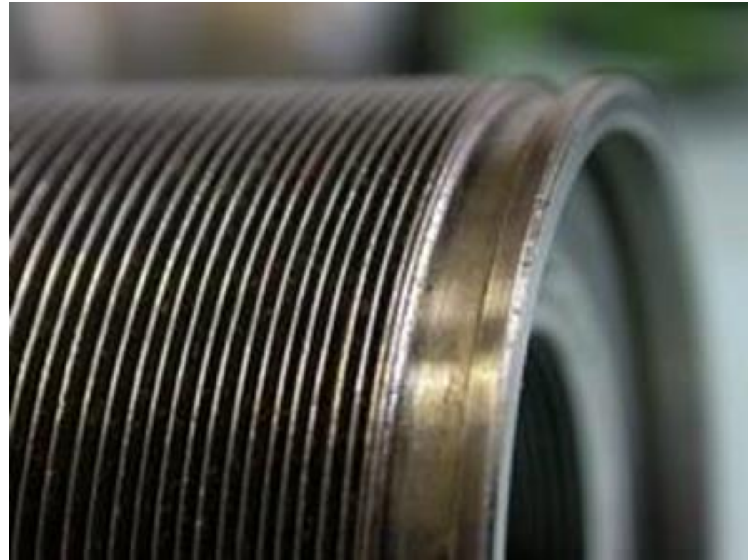
Detail membránového vlnovce. Je svařen elektronovým svazkem z desítek nerezových mezikruží, každé o tloušťce jen 0,05 mm.
