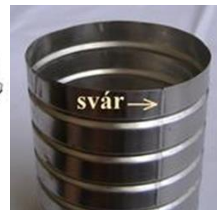
Experiment se spojováním tenkostěnných trubek: průměr 125, stěna 0,25 mm
