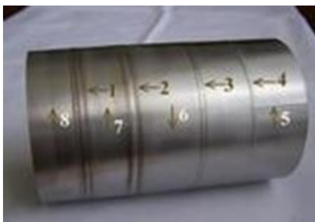
Experiment se spojováním tenkostěnných trubek: průměr 125, stěna 0,25 mm
