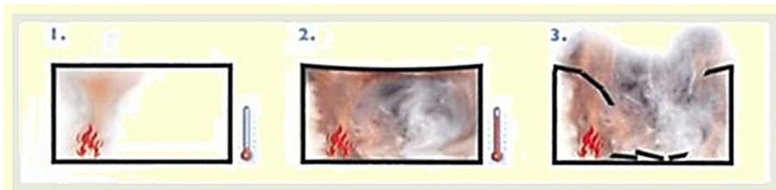
poškození stavby následkem požáru bez zařízení pro odvod tepla a kouře
