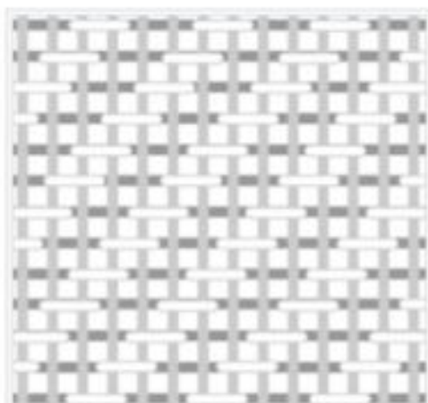
Struktura K2/2 – posunem o jednu osnovní nit doprava na každém útkovém řádku se dosáhne šikmého řádkování
