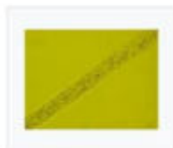
PAN vlákno (polyakrylonitril), surovina pro uhlíková vlákna (400× zvětšeno)
